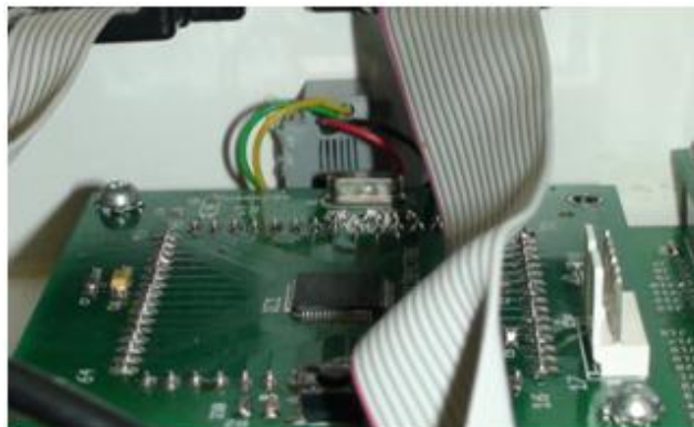
Figura 5.16 - Montagem do módulo DSP contendo o DSPIC33FJ128MC706.
