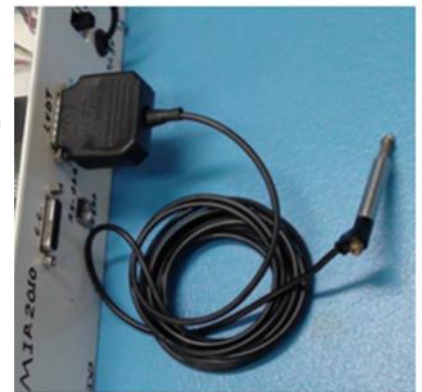
Figura 5.11 - a) Esquema genérico de ligação dos sensores. b) Foto do sensor de deslocamento conectado à interface.
