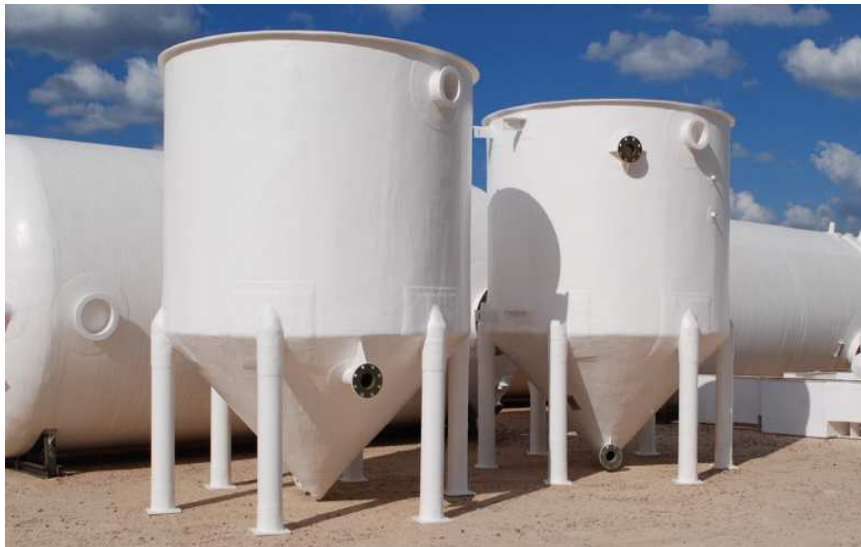
FIGURA 12 - Exemplo equipamento industrial em PRFV.
