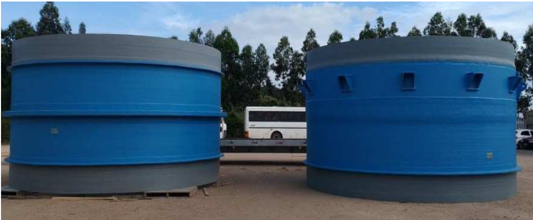
FIGURA 10 - Exemplo equipamento industrial em PRFV.
