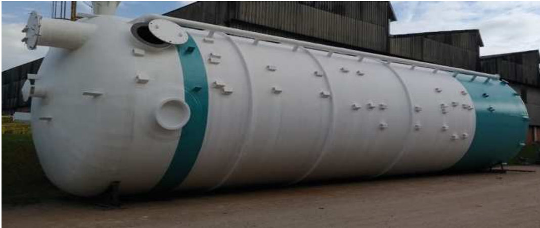
FIGURA 9 - Exemplo equipamento industrial em PRFV.
