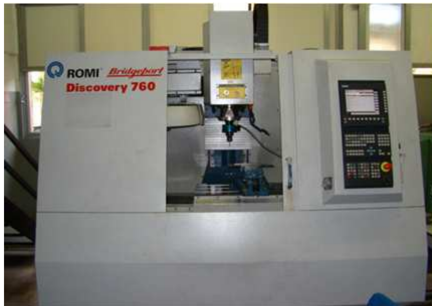
Figura 3.11 - Centro de usinagem CNC, Discovery 760 Romi, utilizada para os ensaios de rosqueamento
