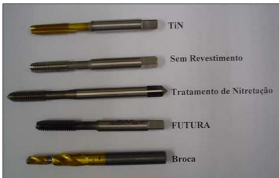
Figura 3.8 – Diferentes machos e a broca utilizada para os ensaios
