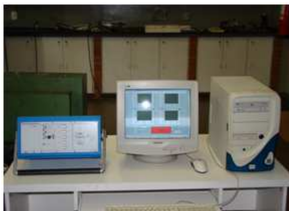
Figura 3.14 – Montagem de parte do sistema de aquisição de sinais de força e torque
