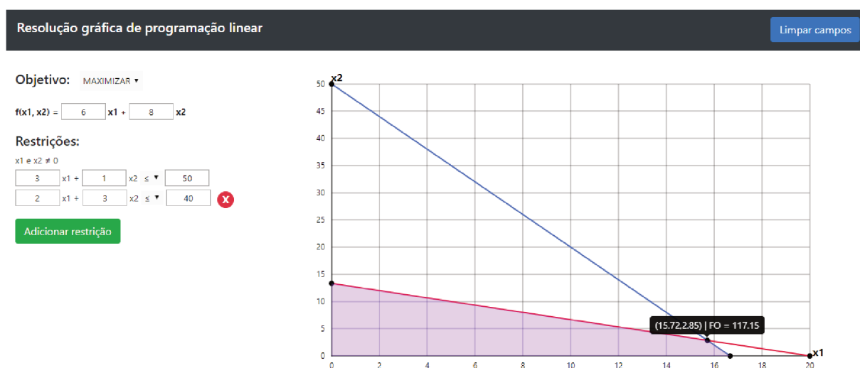
Figura 18 – Exemplo 4.2.2: adição da restrição 2x_1 + 3x_2 \leq 40
