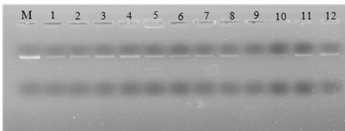
Figura 6: Gel de agarose 0,8% corado com brometo de etídeo. M: DNA do fago M13 padrão 400ng (GE); 1-12: amostras aleatórias do DNA dos clones selecionados no Biopanning in vivo .
