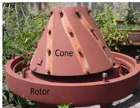
Figura 3.8 - Cone e rotor do secador de cascalho.
