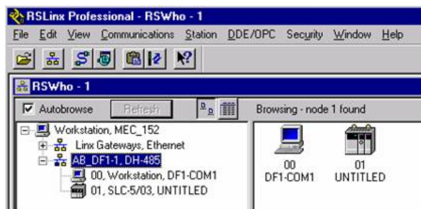
Figura 3.32 - Comunicação programada entre CLP e o computador.
