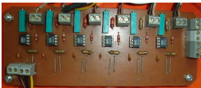
Figura 3.29 - Foto do circuito para o condicionamento dos sinais de pressão, vazão de refrigerante e vazão de água do evaporador.
