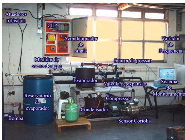
Figura 3.4 - Bancada experimental final com isolamento utilizada para os ensaios.
