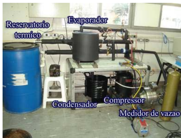
Figura 3.3 - Bancada experimental com isolamento no início dos ensaios.
