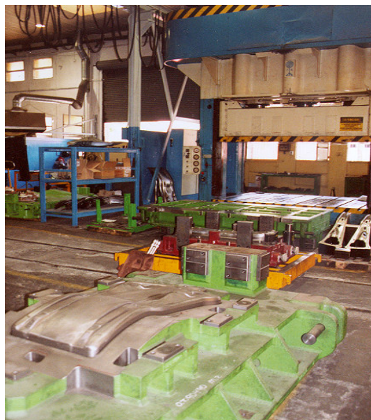
Figura 2.7 – Aspecto de uma prensa e uma matriz com os sulcos dos freios de estampagem, Cortesia Quantech ATZ.
