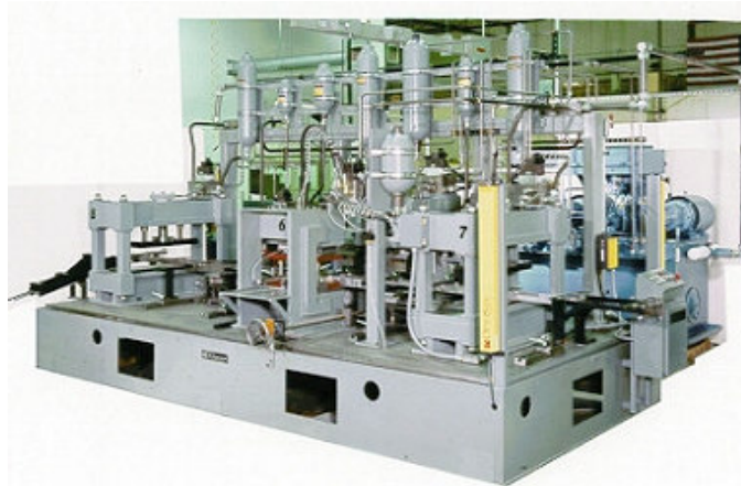
Figura 2.11 – Prensas “ Transfer ” – Cortesia QUANTECH - ATZ
