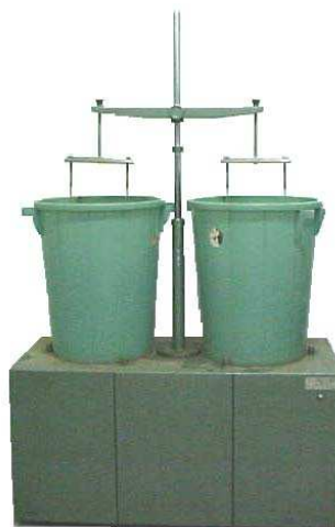
Figura 4. Foto do aparelho utilizado para a determinação dos agregados via úmida
