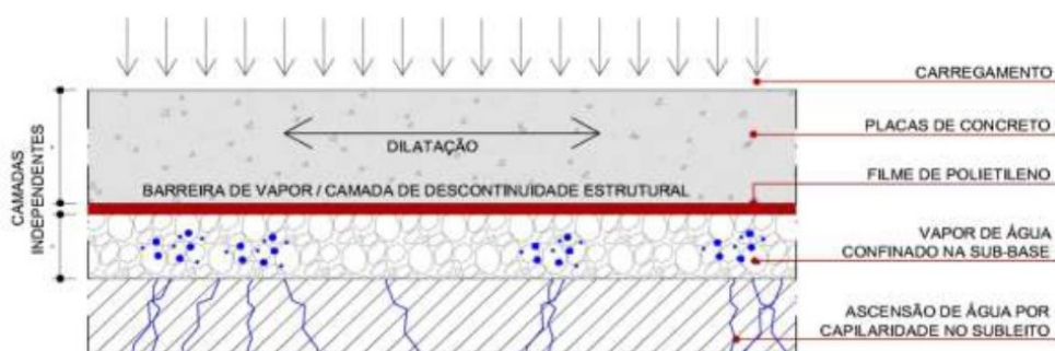
Figura 23- Detalhe da solicitação da barreira de vapor
