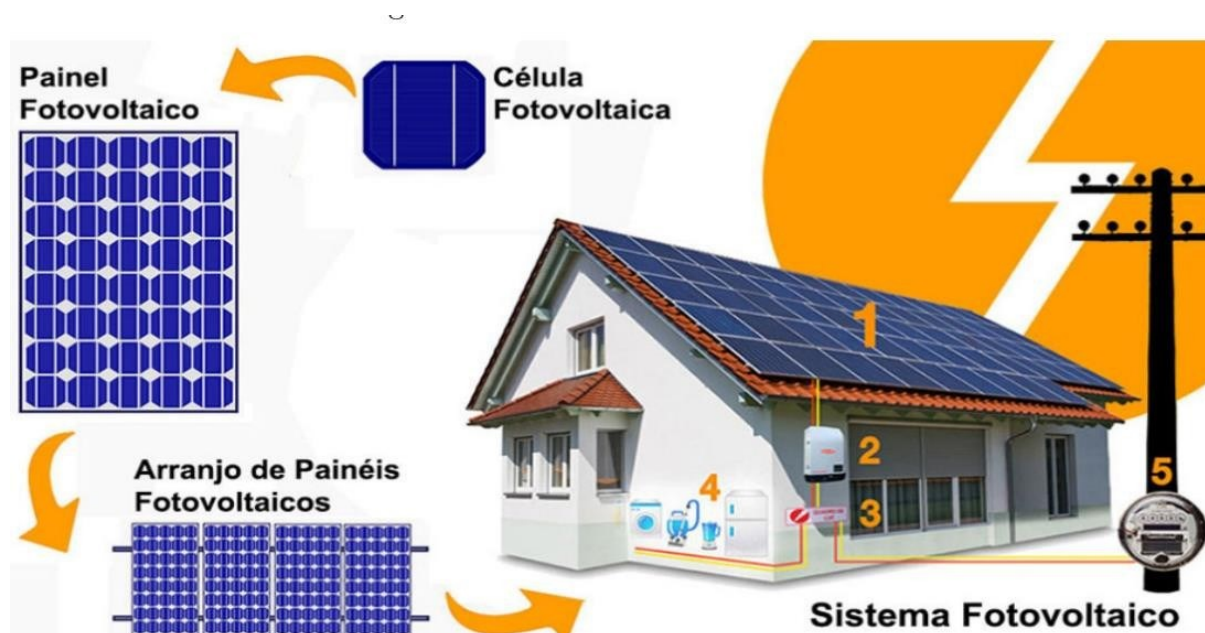
Figura 2 - Sistema conectado à rede [7]
