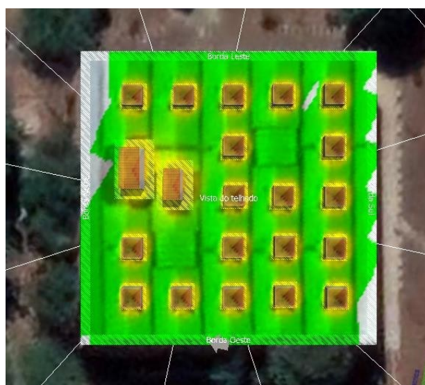
Figura 16 – Índice de sombreamento anual no telhado da biblioteca UFU campus Santa Mônica [Autor].
