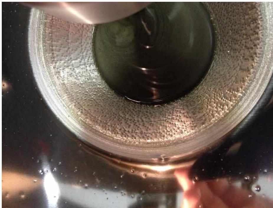
Figura 4.4 - Textura encontrada durante a estampagem SPIF de aço inoxidável AISI 304.
