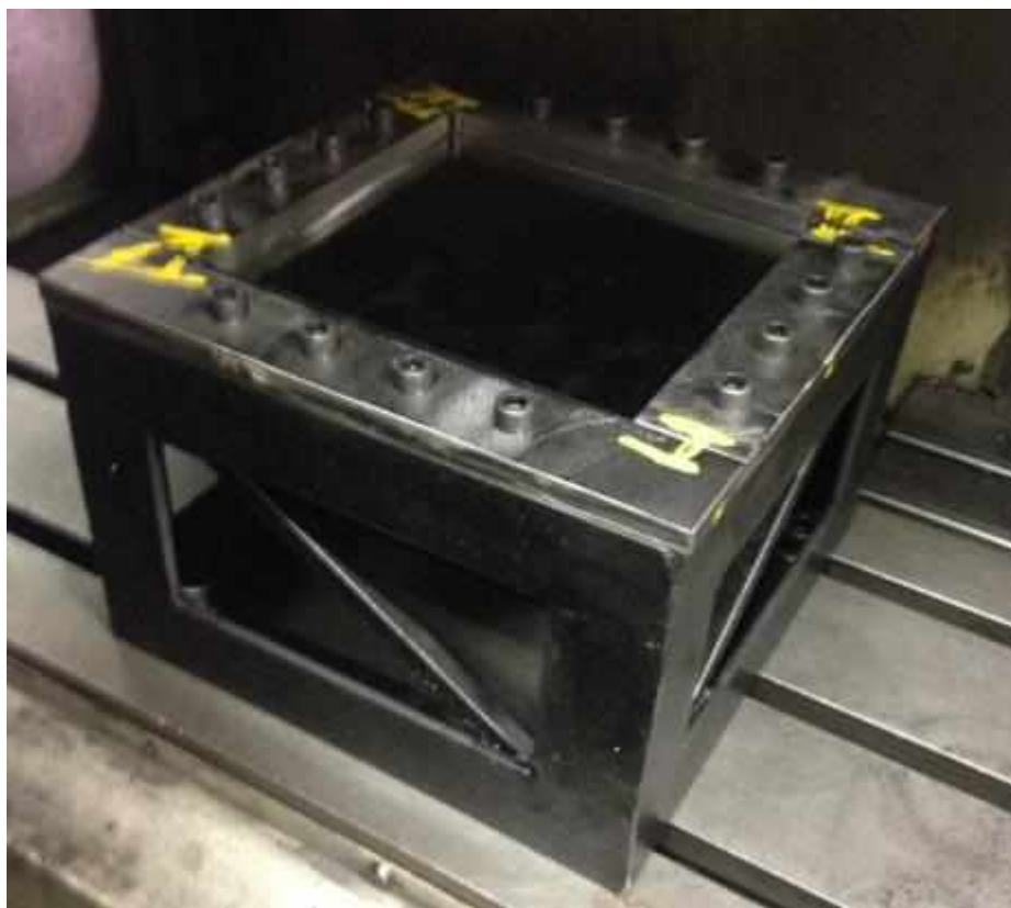
Figura 3.1 - Suporte fixador de chapas metálicas.
