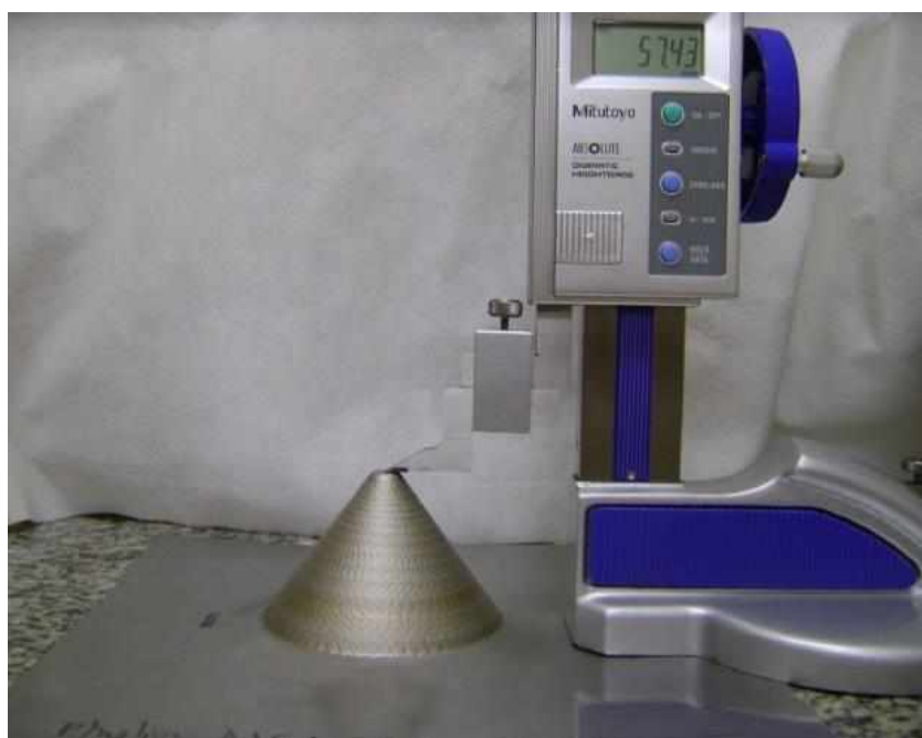
Figura 3.8 - Medição da profundidade do cone de aço inoxidável AISI 304 estampado incrementalmente por ponto único a 2000 rpm.
