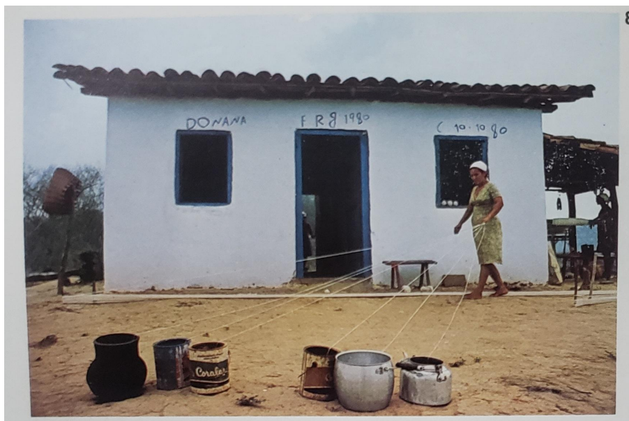
Figura 15 - Artesã prepara a urdidura no chão, observando-se os diversos recipientes, cada um contendo um novelo de fios
