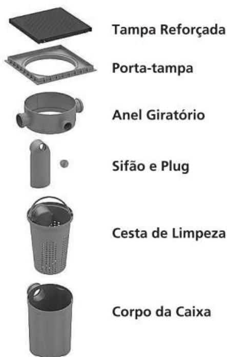
Figura 67 – Elementos da caixa de gordura da Tigre®
