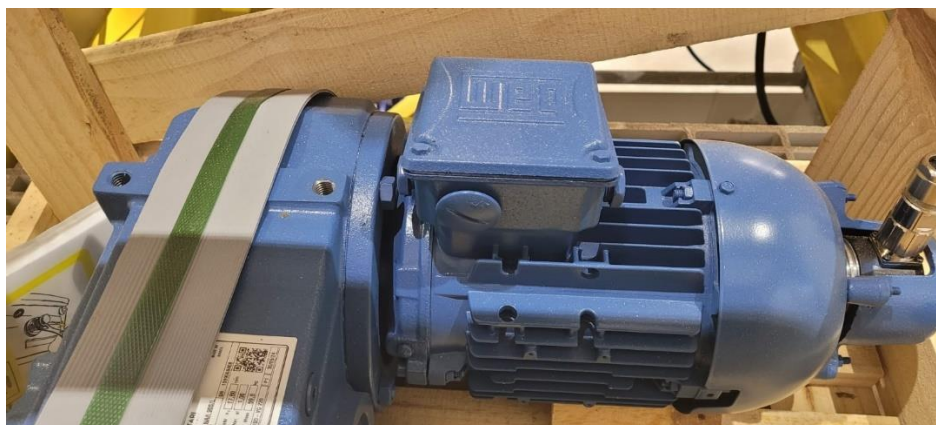
Figura 9 - Motor WEG W21 acoplado com um motorreductor WEG Cestari.
