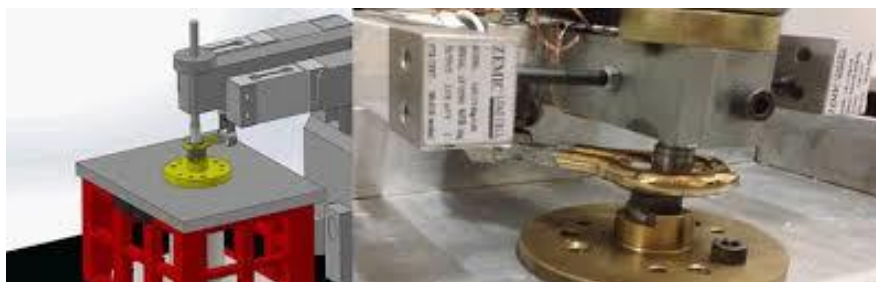
Figura 4 - Tribômetro universal nos tipos pino ou bola sobre disco.
