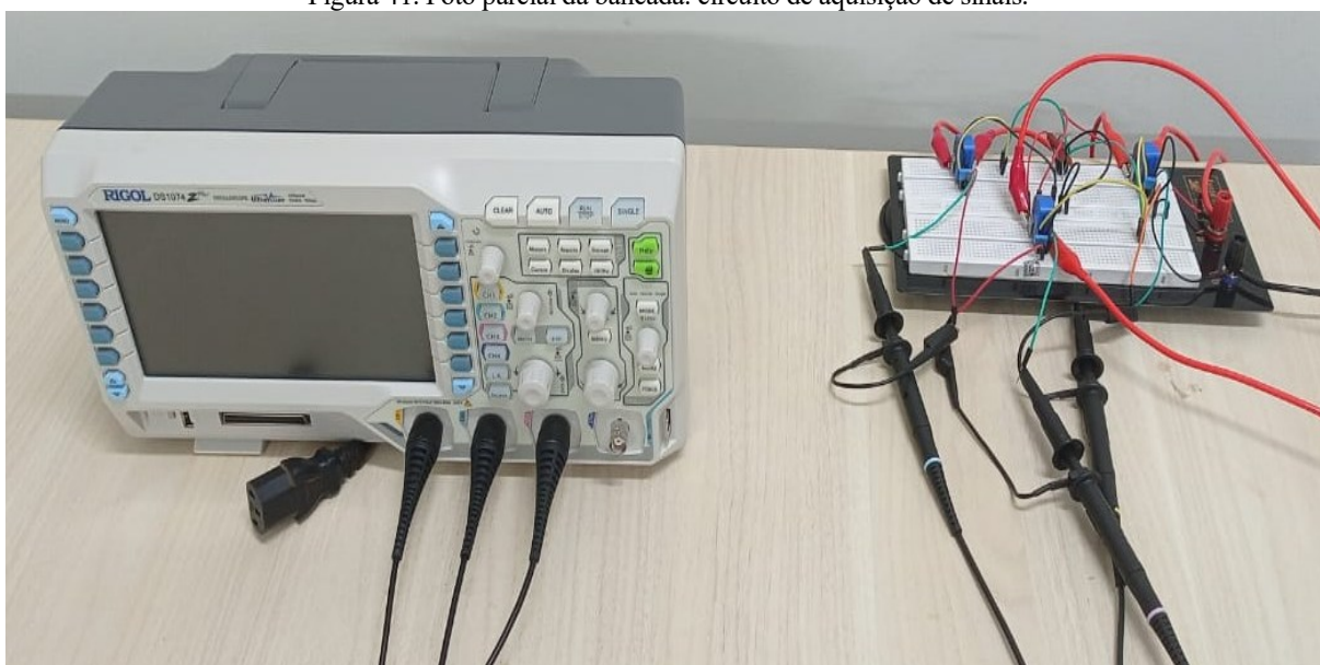
Figura 41. Foto parcial da bancada: circuito de aquisição de sinais.
