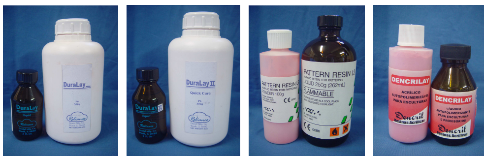
Figura 9. Resinas acrílicas ativadas quimicamente utilizadas no estudo: a) Duralay I; b) Duralay II; c) GC Pattern e d) Dencrilay.
