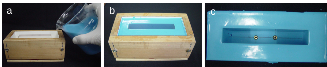
Figura 4. Obtenção do molde de silicone: a) silicone sendo vertida no interior da caixa de madeira; b) caixa preenchida com silicone; c) transferentes posicionados no interior do molde após a remoção da caixa.
