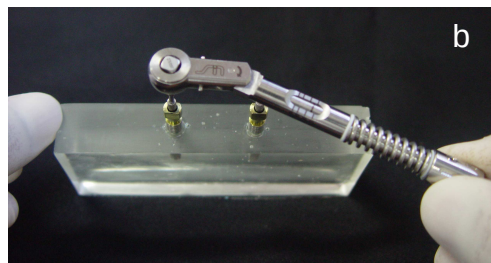
Figura 6. Polariscópio. Figura 7. a) Transferentes posicionados sobre os implantes no modelo fotoelástico; b) parafusos de trabalho com torque de 10N.
