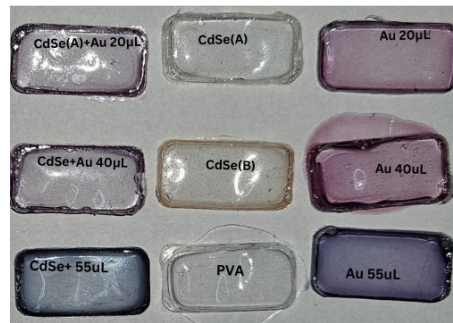
Figura 3.3: Filmes produzidos neste trabalho, com diferentes composições de PQs de CdSe e AuNBs.
