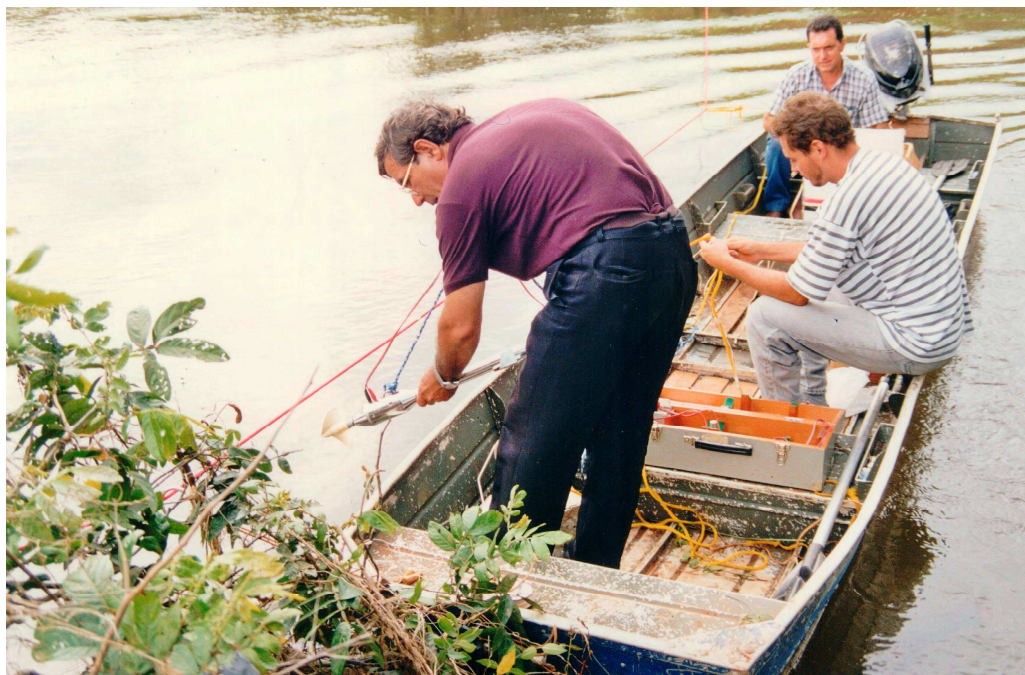
FOTO 5 – Medida de vazão com molinete
