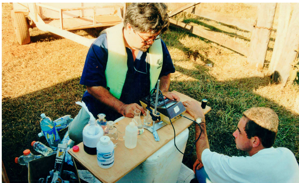
FOTO 4 – Determinação do pH da amostra
