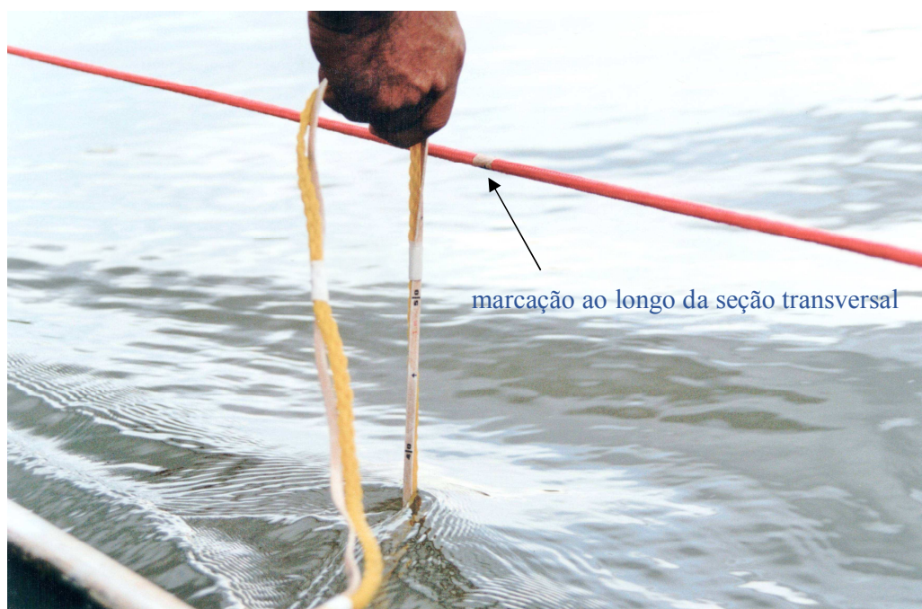
FOTO 6 – Detalhe da localização e do controle da profundidade do molinete
