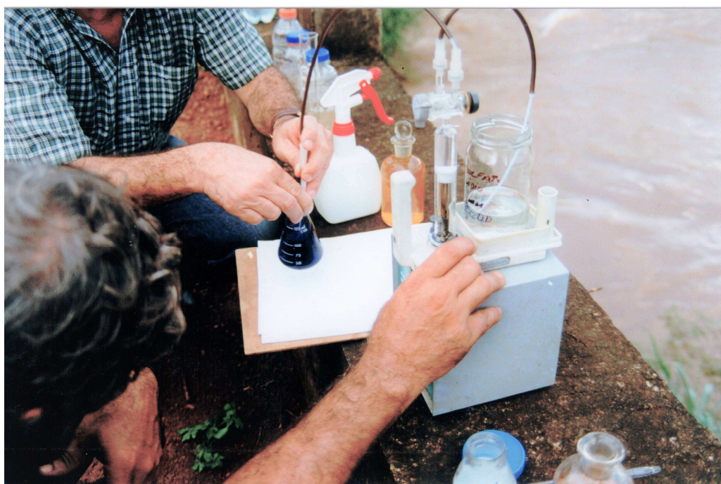
FOTO 3 – Titulação da amostra para determinação do OD em campo
