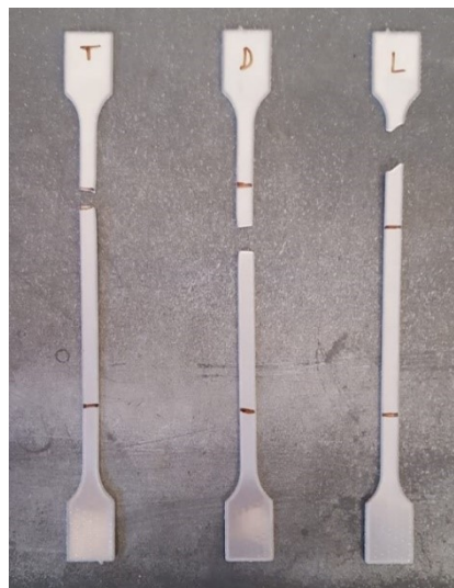
Figura 15: Corpos de prova após os ensaios de tração. Escala 1:3.
