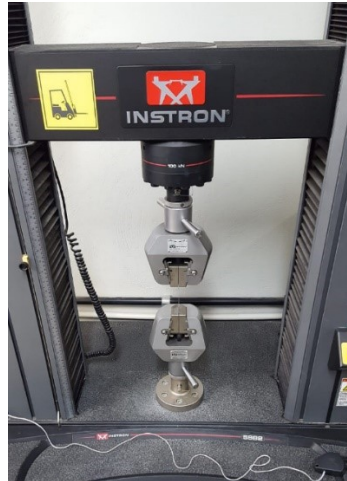
Figura 8: Equipamento utilizado nos ensaios de tração
