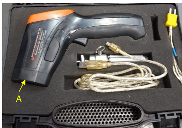
Figura 12: Termômetro FLIR® 42570 (A) utilizado durante os ensaios.
