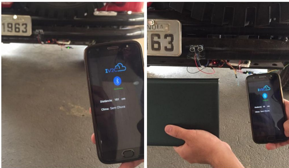
Figura 10 – Teste realizado com o sensor de distância
