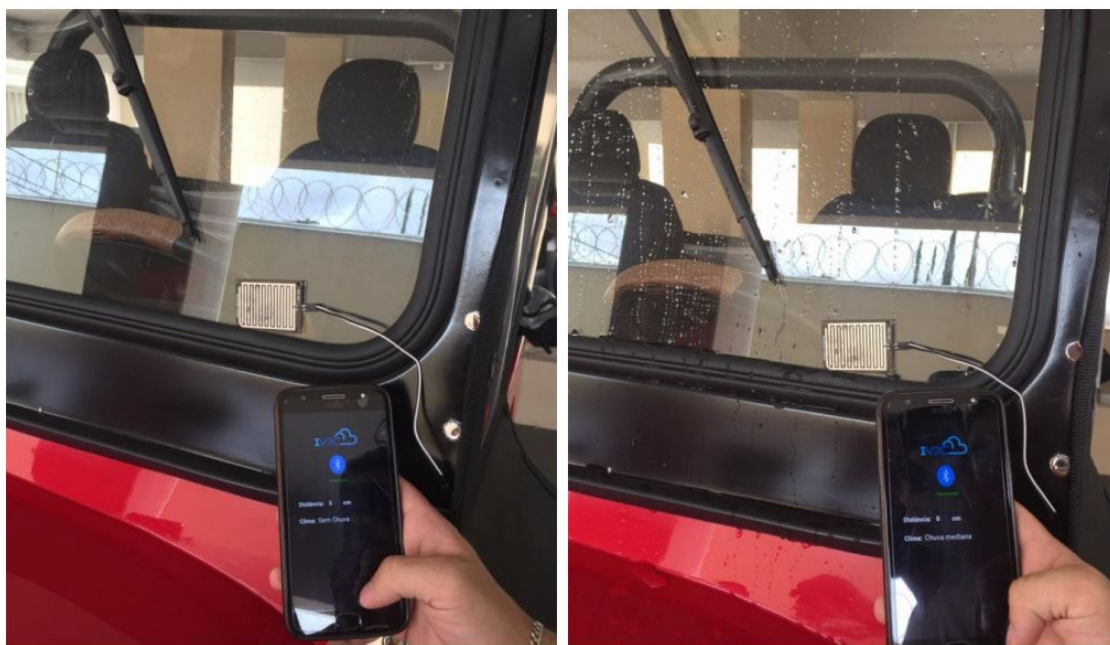
Figura 9 – Teste realizado com o sensor de chuva
