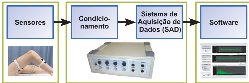
Figura 1.1: Arquitetura típica de um instrumento biomédico
