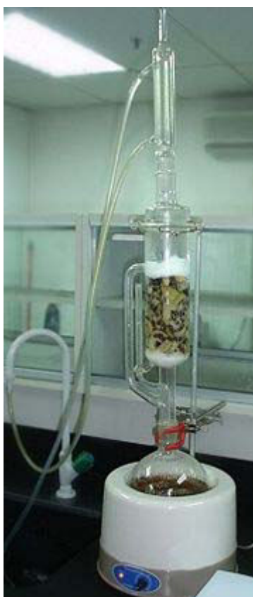
Figura 9: Montagem para extração contínua utilizando o aparelho de Soxhlet.
