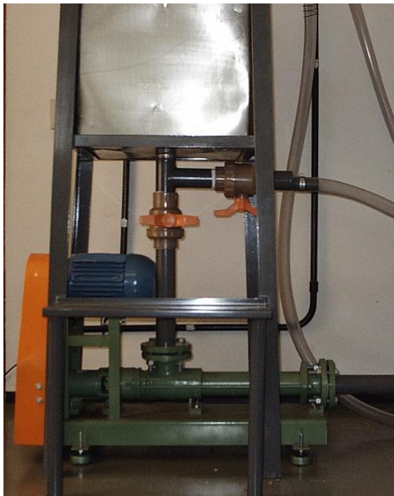
Figura 3.14: Arranjo da bomba helicoidal e seus acessórios.
