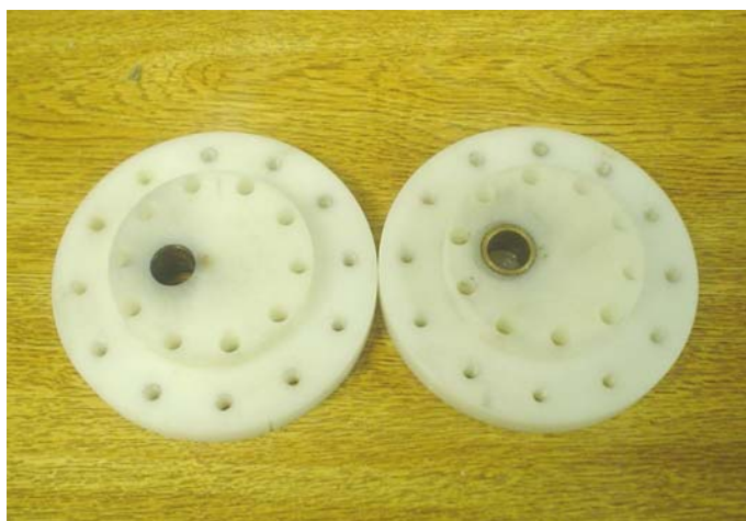
Figura 3.9: Detalhes dos flanges para o arranjo excêntrico.
