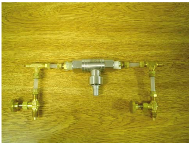
Figura 3.17: Detalhes do transdutor de pressão e válvulas para eliminação de bolhas.
