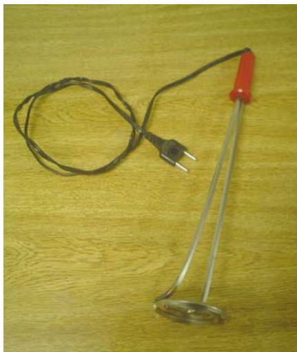
Figura 3.2: Foto do aquecedor elétrico.
