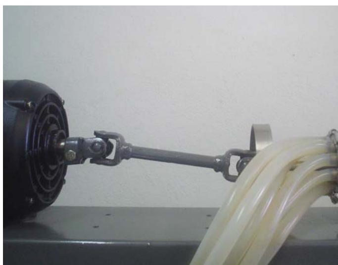
Figura 3.13: Detalhes do acoplamento entre eixos.
