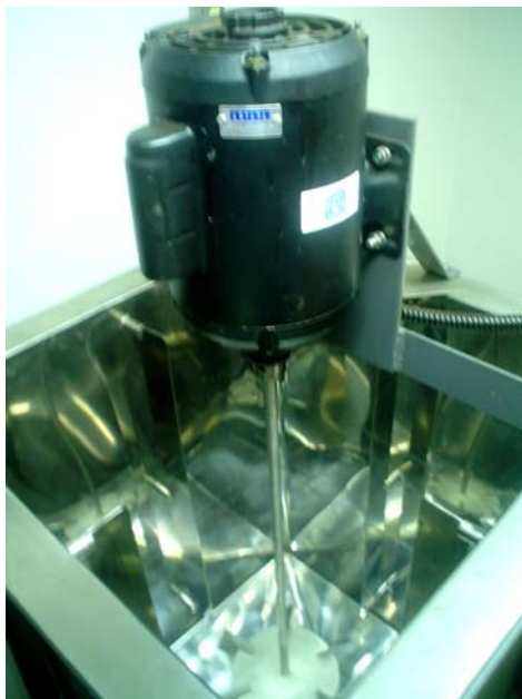
Figura 3.6: Detalhes do tanque de homogeneização.
