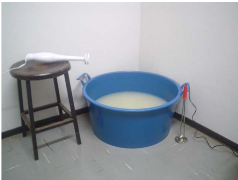
Figura 3.4: Preparo de uma batelada de 46 litros de solução polimérica.
