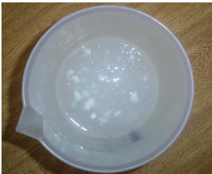
Figura 3.3: Efeito do modo de adição de polímero na qualidade da suspensão.
