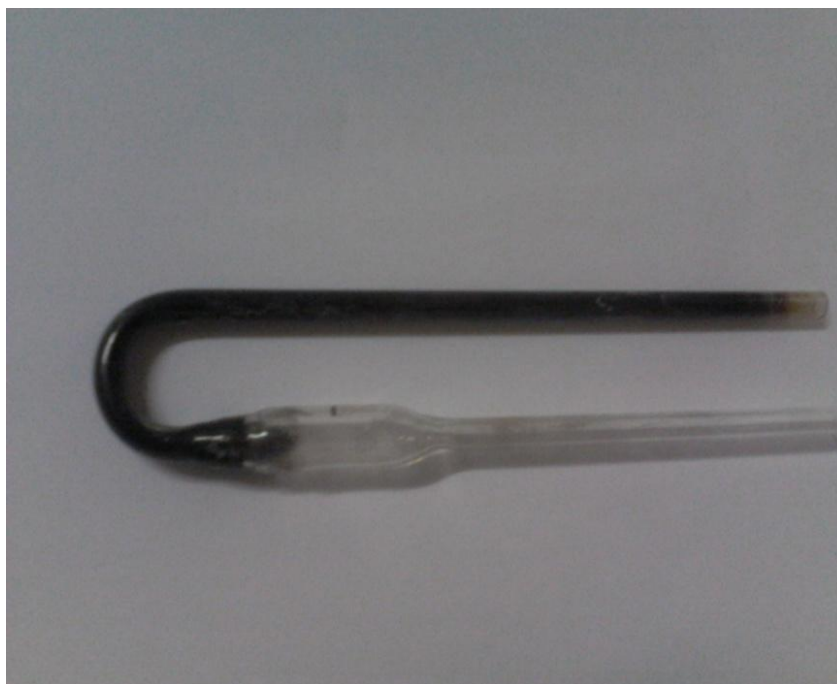
Figura 4.54 -Foto do reator após 24 de reação utilizando o precursor básico a 873K, 10mg de catalisador diluído em 130mg de quartzo, fluxo total de 205 cm 3 /min, H 2 O/ácido acético = 1,3, O 2 / ácido acético= 0,18, H 2 O/ácido acético/O 2 = 13%/11%/2%.
