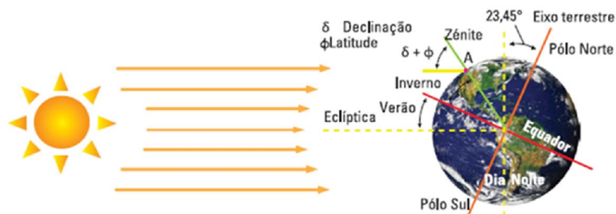
Figura 2.14 - Incidência dos raios solares nos hemisférios da Terra
