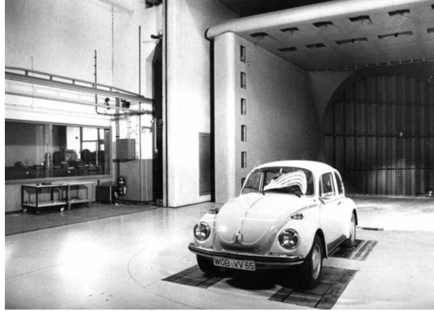
Figura 3 - Veículo em túnel de vento para teste aerodinâmico (Disponível em: https://pt.wikipedia.org/wiki/Túnel_de_vento . Acessado em: 12 de outubro de 2017)
