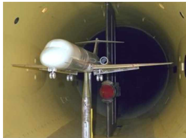
Figura 4 - Protótipo de avião em túnel de vento da NASA (Disponível em: https://pt.wikipedia.org/wiki/Túnel_de_vento . Acessado em: 12 de outubro de 2017)
