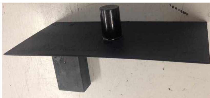
Figura 25 - Protótipo de placa horizontal com cilindro circular, de diâmetro de 3 cm, em cima
