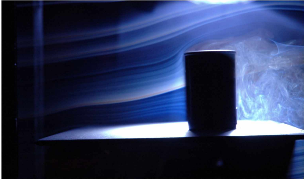
Figura 36 - Escoamento através de placa com cilindro em cima.
