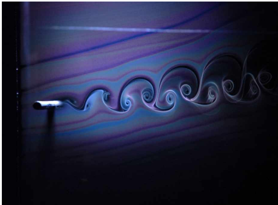
Figura 29 - Escoamento ao redor do protótipo cilíndrico
