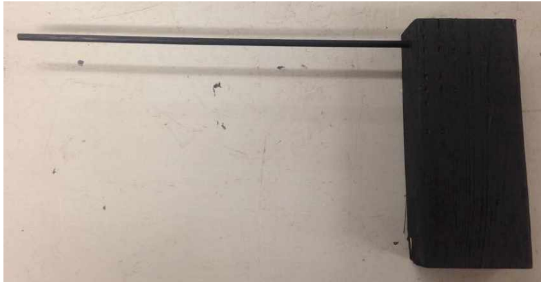
Figura 21 - Protótipo no formato cilíndrico circular com diâmetro de 0,5cm
