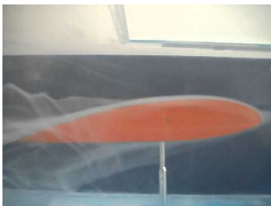
Figura 7 - Exemplo de túnel utilizando fumaça para estudo de escoamento em aerofólio (Disponível em: https://www.google.com.br/url?sa=i&rct=j&q=&esrc=s&source=images&cd=&cad=rja&uact=8&ved=0ahUKEwi1t62ts8HXAhUBOZAKHdWXAdQQjRwIBw&url=https%3A%2F%2Fwww.youtube.com%2Fwatch%3Fv%3DlGpEjfkMYp0&psig=AOvVaw0ZmeGVI_l3O8Lo6oj3g-5&ust=1510863476386200 . Acessado em: 15 de novembro de 2017)
