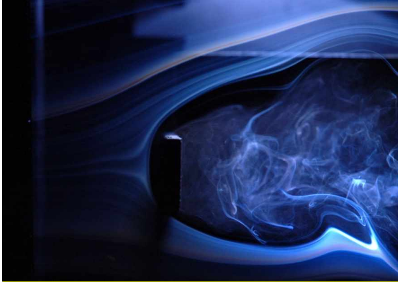
Figura 34 - escoamento através de placa vertical.
