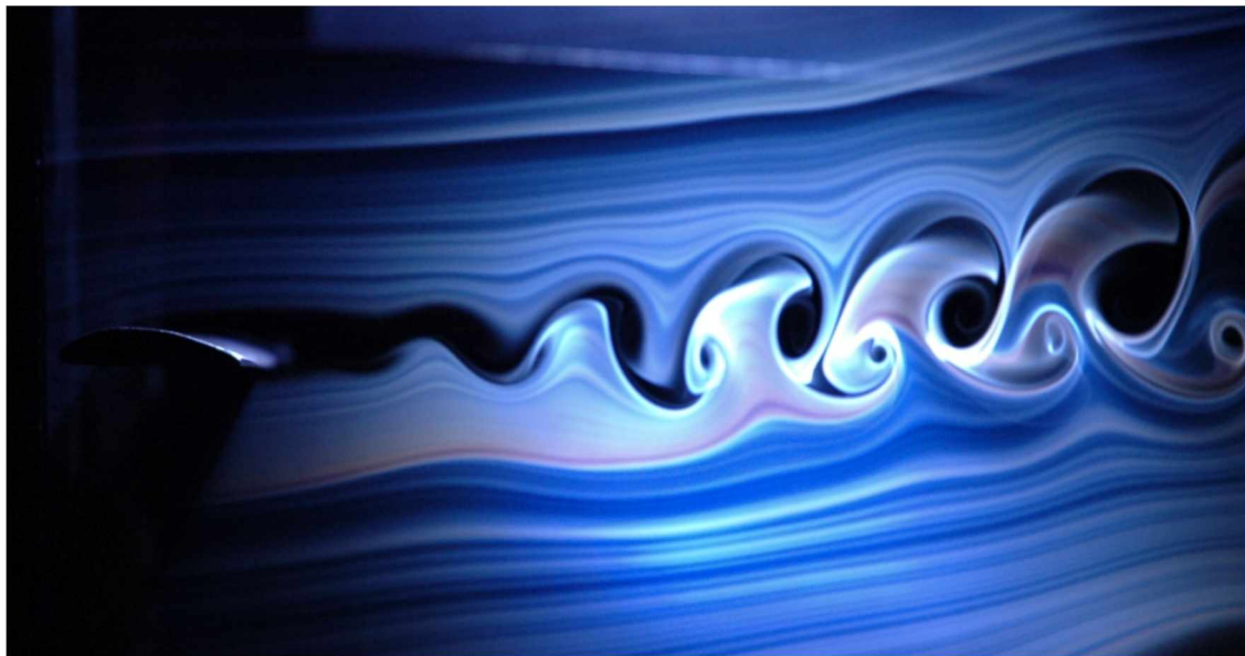
Figura 32 - Escoamento ao redor do aerofólio com AOA = 0^\circ .
