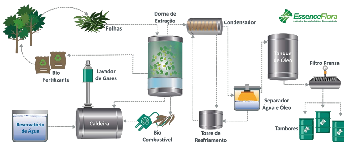
Figura 3. Esquema de uma destilaria de óleo essencial de eucalipto baseando-se no princípio de destilação a vapor.
