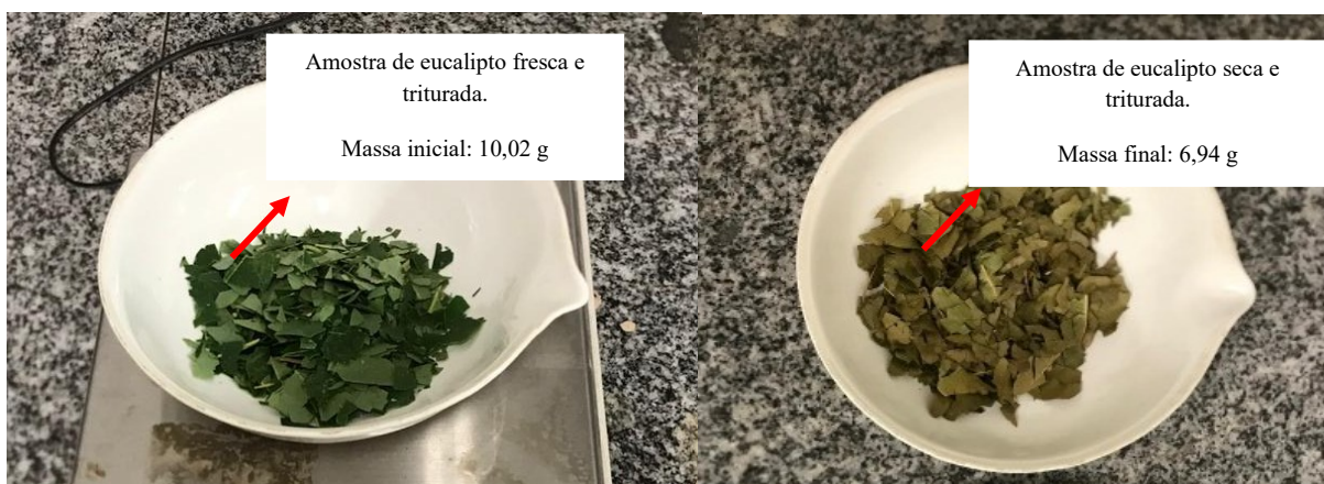
Figura 8. Determinação da umidade por dessecação da folha de eucalipto fresca e triturada.
