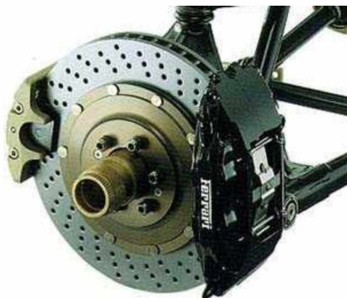
Figura 5: Disco de freio perfurado. (Fonte: Apostila - Introdução a freios automotivos – UNICAMP)
