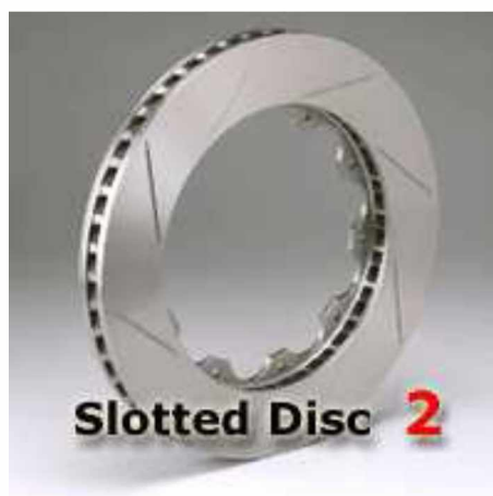
Figura 6: Disco de freio ranhurado. (Fonte: Fundamentos de freios e seus componentes )
