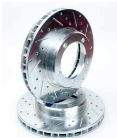
Figura 7: Disco de freio ventilado-perfurado-ranhurado. (Fonte: Fundamentos de freios e seus componentes )
