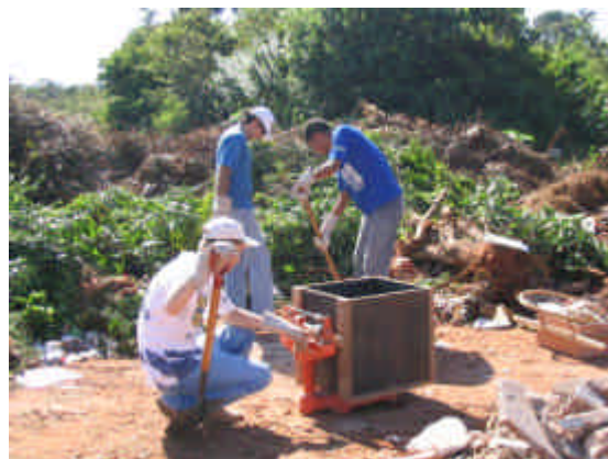
Figura 3.3 – Coleta e pesagem de amostras dos RCD.
