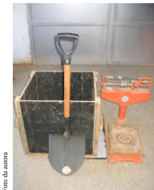
Figura 3.2 – Equipamentos utilizados na quantificação dos RCD.
