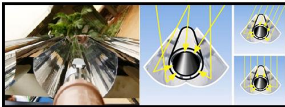
Figura 8. Detalhe da superfície refletora do CPC. Fonte: (Mendonça Duarte, Xavier et al. , 2005).
