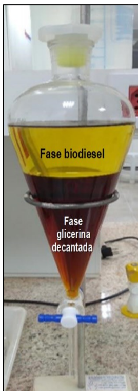
Figura 42 - Funil de decantação com fase biodiesel (superior) e fase glicerina decantada (inferior)
