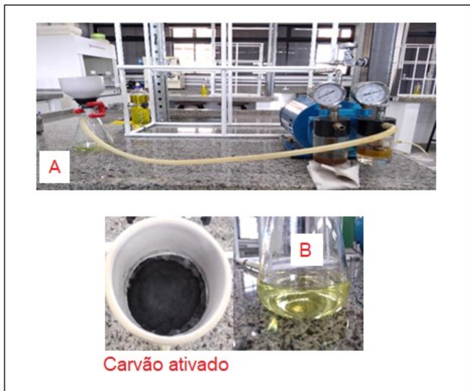
Figura 46 – A) Sistema de filtração (à vácuo) para remoção do carvão ativado da glicerina loira. B) Glicerina loira
