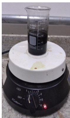
Figura 45 – Sistema com fase glicerina loira e carvão ativado sob agitação magnética
