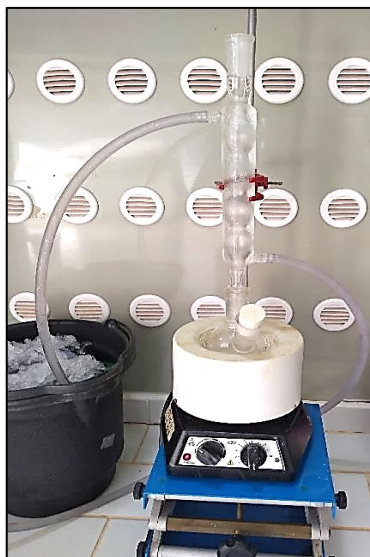
Figura 39 – Sistema de refluxo para reação de esterificação
