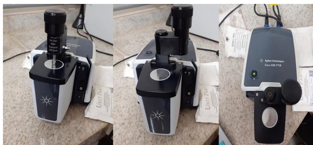
Figura 40 – Espectrômetro de absorção na região do infravermelho Agilent Technologies ® Cary ® 630 FTIR ®
