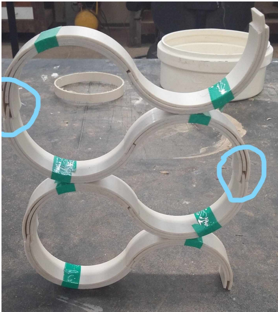
Imagem 16: Empilhando 4 peças “S”, os encaixes em destaque não ficaram estáveis
