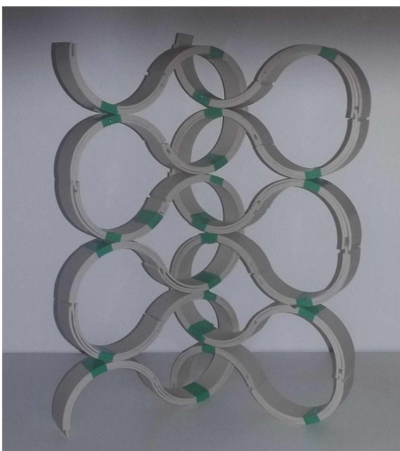
Imagem 18: Alterando a posição das pilhas e acrescentando peças para testar o equilíbrio, a estrutura não suportou o peso e caiu, durante a montagem os encaixes se soltaram diversas vezes.
