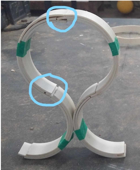
Imagem 15: Encaixe de duas peças “S”, as áreas selecionadas apresentam falhas nos encaixes.
