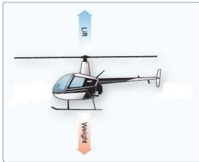
Figura 15: Forças no helicóptero durante o voo vertical (Fonte: http://www.danubewings.com/helicopter-hovering-flight/ - adaptado pelo autor)
