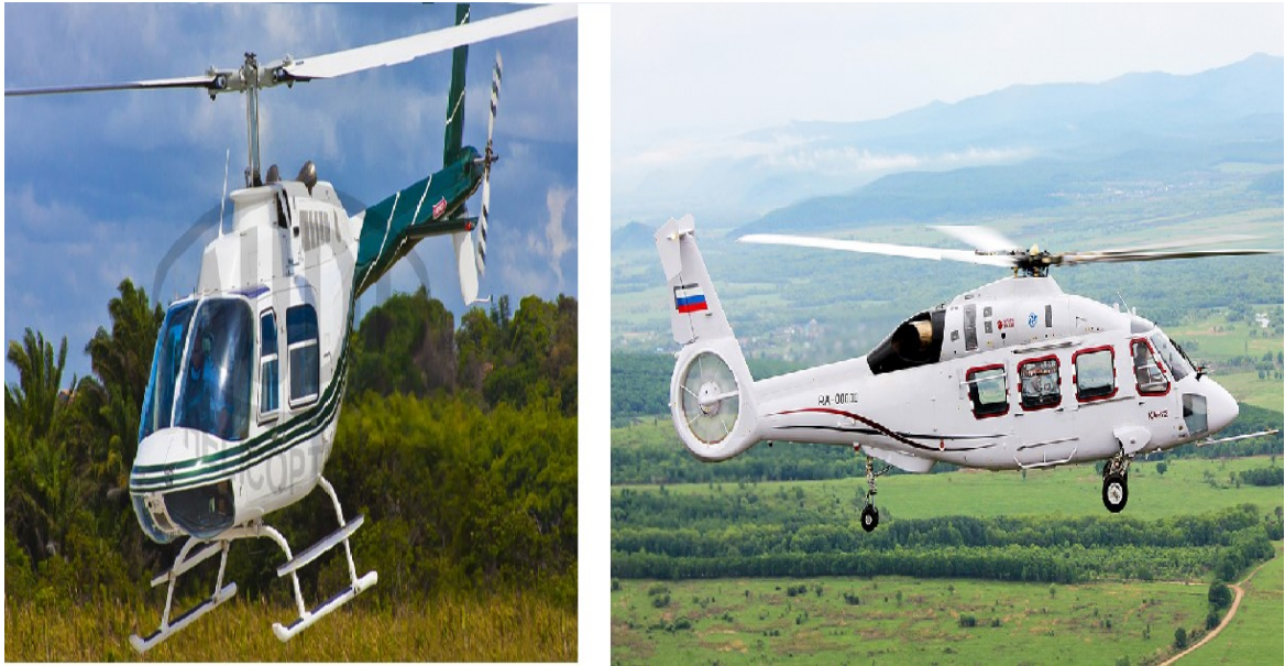
Figura 7: Helicópteros com rotores simples. Na esquerda Bell 206 - sem o sistema fenestron, na direita Kamov Ka-60 - com o sistema fenestron. (Fonte: https://br.rbth.com/defesa/2017/06/21/ka-60-de-helicoptero-militar-a-limusine-aerea_787105 )
