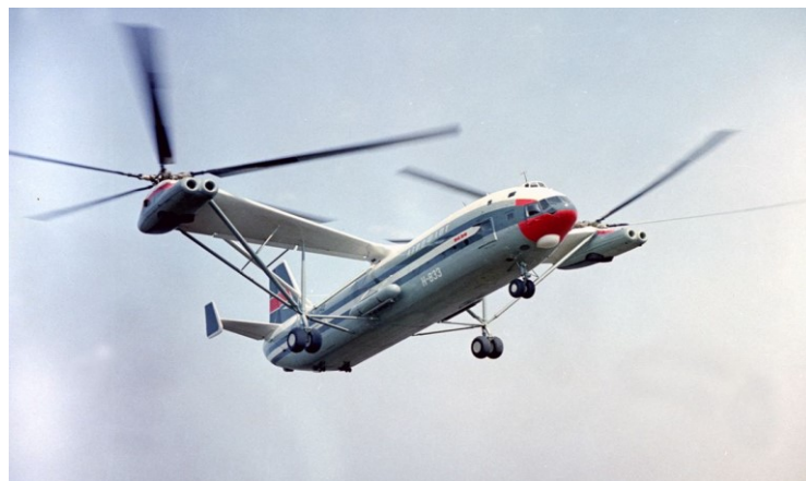
Figura 11: Helicóptero com rotor duplo - Mil mi 12 (Fonte: Machado e Reisdorfer, 2015)
