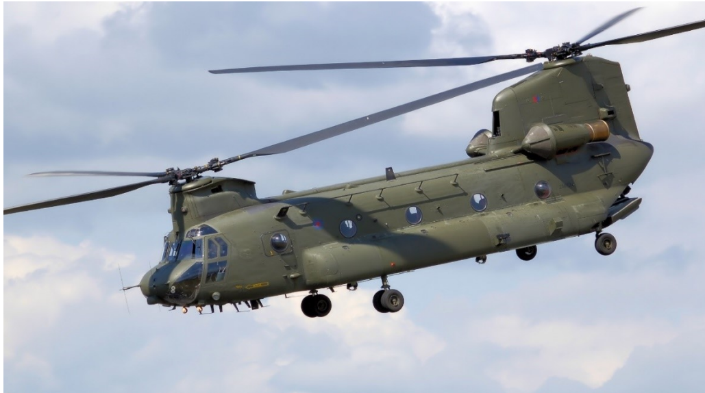
Figura 8: Helicóptero com rotor tandem – Boeing CF47 (Fonte: https://en.wikipedia.org/wiki/Boeing_Chinook_(UK_variants)) )
