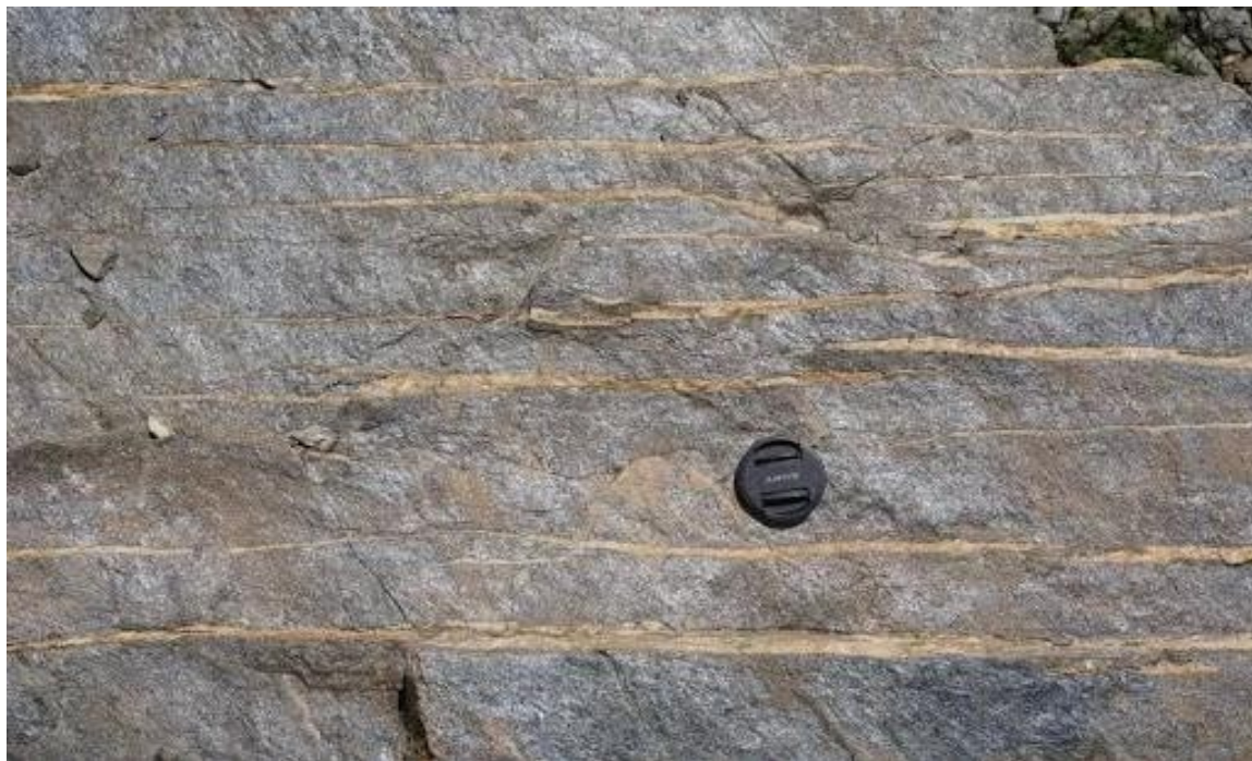
Figura 11: Maciço rochoso com descontinuidades persistentes e preenchidas.
