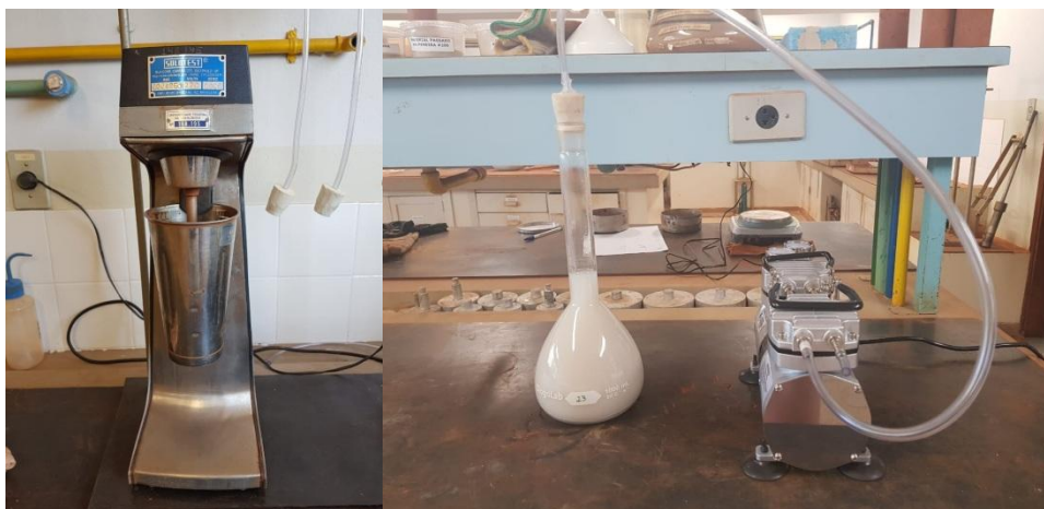
Figura 5 - Ensaio de determinação da massa específica dos grãos
