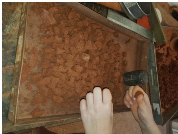
Figura 11 - Destorroadamento do solo para ensaio com reuso
