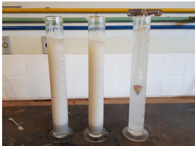
Figura 6 - Ensaio de Sedimentação
