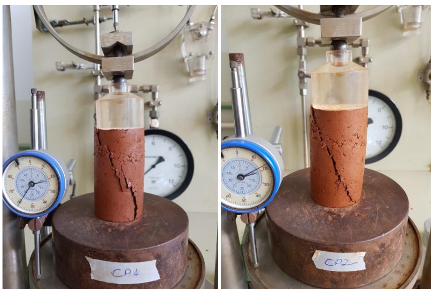
Figura 20 - (a) Ruptura Corpo de Prova 1 (b) Ruptura Corpo de prova 2 - Mistura Solo e Resíduo de Vidro
