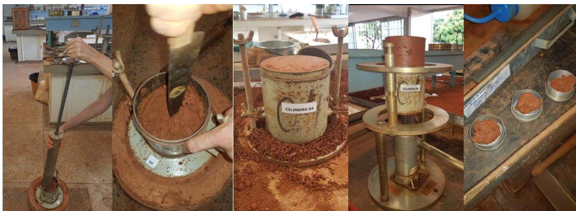
Figura 12 - Ensaio de compactação da mistura solo e vidro
