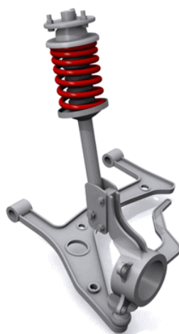
Figura 2.21 – Exemplo de Suspensão MacPherson. (Longhurst, 2004)
