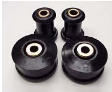
Figura 2.11 – Buchas de borrachas de suspensões veiculares. (Fonte: Adams, 1993).
