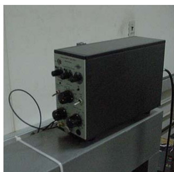
Figura 6.6- Condicionador de Sinal Utilizado nos Ensaios.
