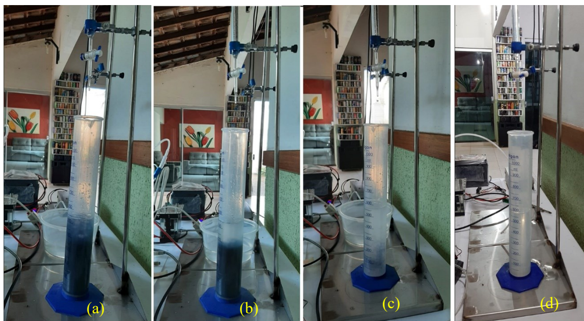
Figura 3.5 – Procedimentos da titulação – fases da segunda titulação: (a) 1 min, (b) 1,5 min, (c) 2 min, (d) 3 min.
