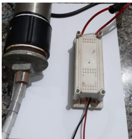
Figura 4.7. Driver de excitação MAT do reator de ozônio.
