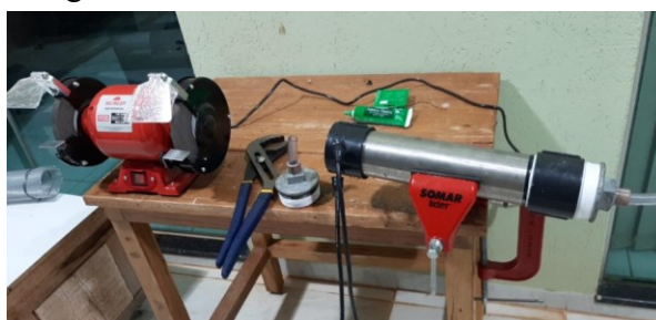
Figura 3.19 - Montagem do reator de ozônio em bancada.
