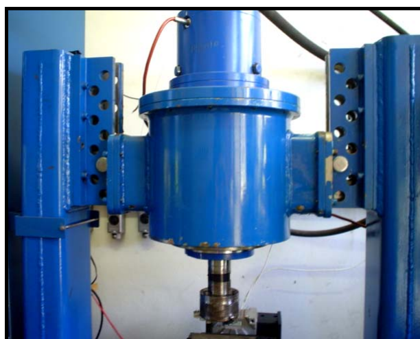
Figura 3.2: Montagem da cabeça de reparo no pórtico.
