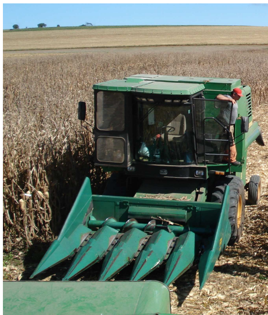
Figura 8. Colhedora de parcelas de cinco linhas, comercializada pela empresa John Deere®, utilizada nos ensaios de Iraí de Minas, Nova Resende e Jataí sobre Influência de fungicida e adubação foliar em características agrônômicas e sanitárias da cultura do milho. Uberlândia-MG, 2011.
