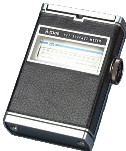
Figura 6: Reflectômetro comercial “Eyetone” para medidas quantitativas de glicose fabricado pela Ames Corporation (ZALOKER-ZALOKER, 2013).
