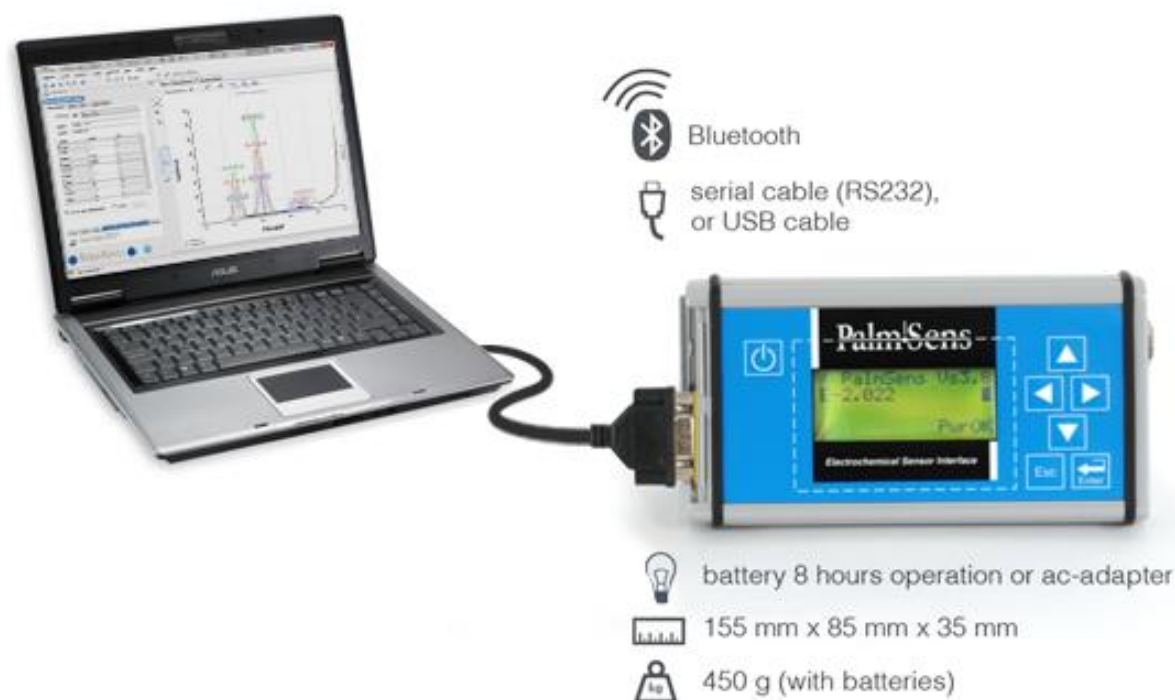
Figura 17: Potenciostato portátil PalmSens acoplado à um notebook para aquisição de dados, e algumas características do equipamento.
