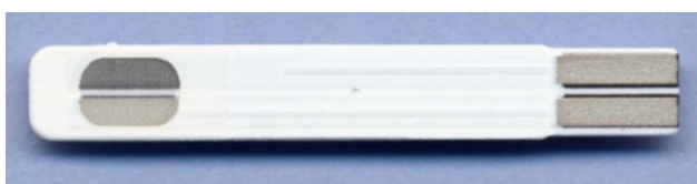
Figura 10: Foto ilustrativa do primeiro biossensor impresso comercialmente, disponível para leitura de glicose.
