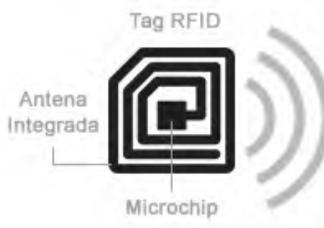
Figura 21: Esquema ilustrativo de uma tag e seus componentes
