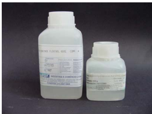
Figura 5.4 – Recipientes das Soluções A e B (Fabricante Polipox), um dos possíveis materiais para produção do material dos corpos de prova.
