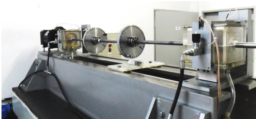
Figura A1.4 – Bancada de testes experimentais dotada de mancais hidrodinâmicos cilíndricos presente no Laboratório de Sistemas Mecânicos (UFU).
