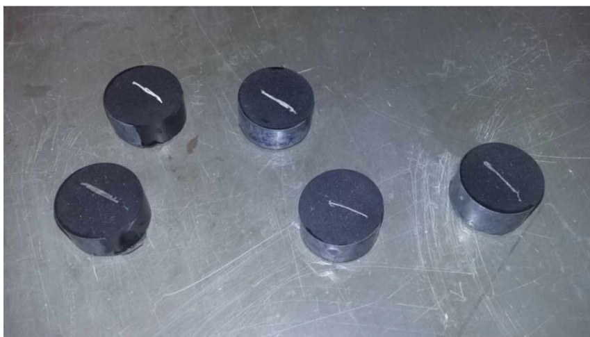
Figura 3.7– Amostras de alumínio puro embutidas, lixadas, polidas e atacadas, antes da micrografia.
