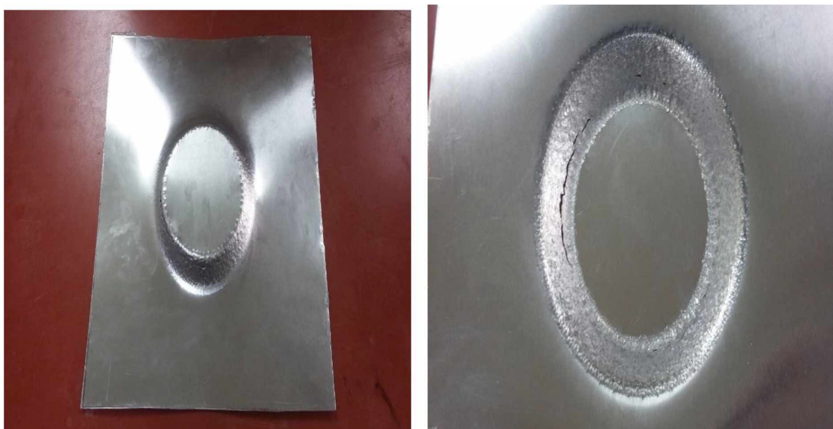
Figura 4.4 – Peça estampada após teste 4. a) Vista superior da peça. b) Detalhe do acabamento superficial e da trinca gerada.
