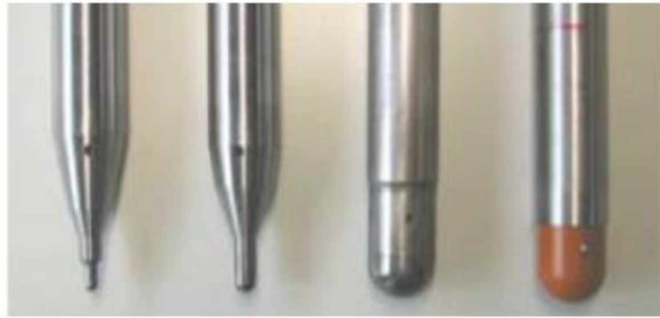
Figura 2.16 – Ferramentas do processo de Estampagem Incremental com diferentes diâmetros. (Fonte: HIRT, 2004)
