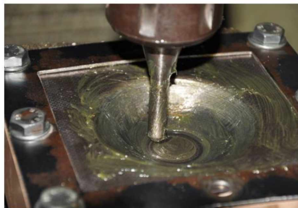
Figura 2.17 – Lubrificação no processo de Estampagem Incremental (Fonte: CASTELAN, 2010)
