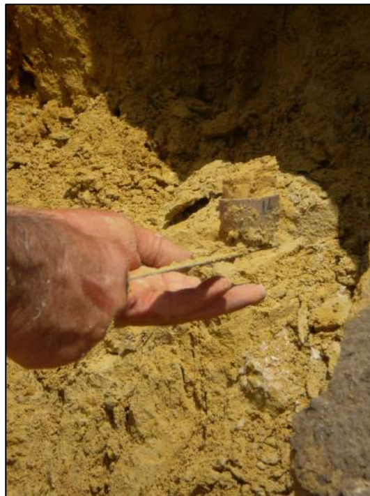
Figura 36: Amostragem indeformada de solo em cilindro.
