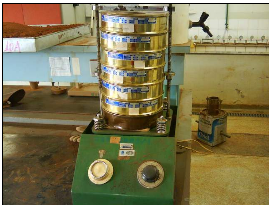
Figura 37: Peneiramento Grosso no ensaio de granulometria. Autor: GIFFONI, S. Data: 09 fev. 2009.
