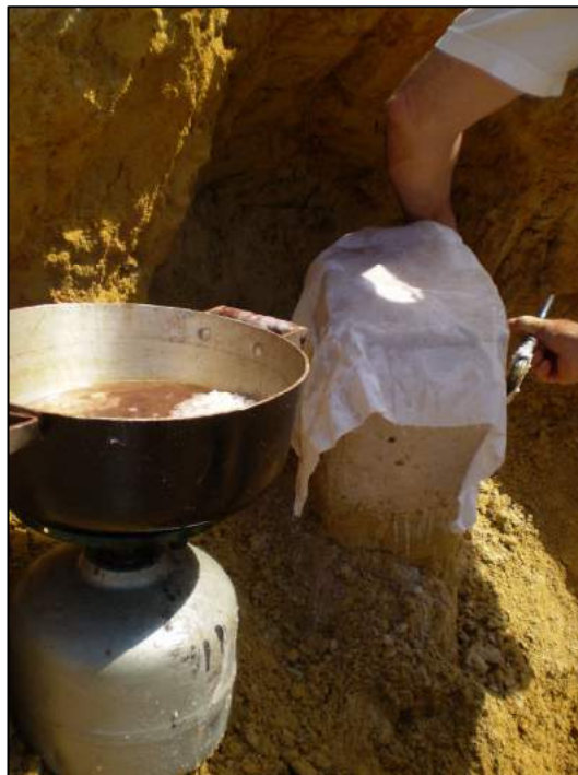
Figura 34: Amostragem de solo para obtenção da amostra indeformada. Autor: GIFFONI, S. Data: 01 set. 2009.
