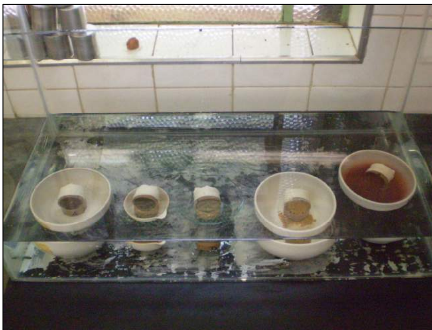
Figura 42: Ensaio de Erodibilidade. Perda por imersão.
