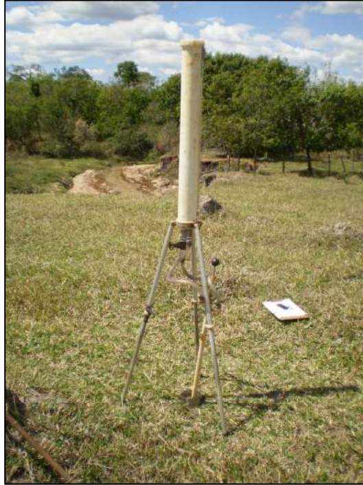
Figura 43: Permeômetro de Guelph. Ensaio de Permeabilidade. Autor: GIFFONI, S. Data: 02 set. 2009.
