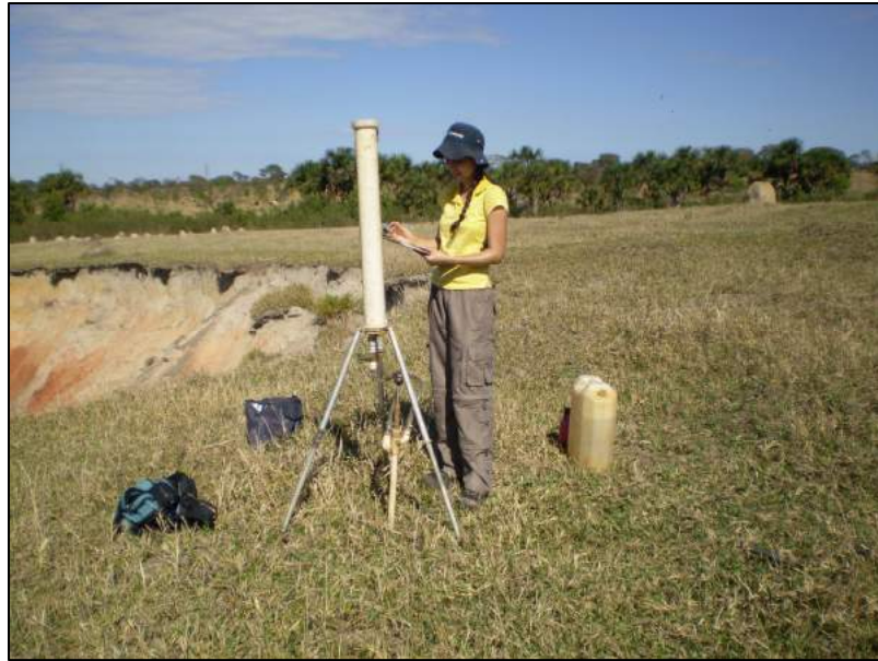
Figura 35: Ensaio de permeabilidade com permeâmetro de Guelph.
