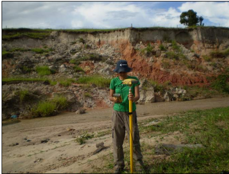
Figura 33: Levantamento com GPS geodésico no trecho de maior velocidade de erosão. Autor: GIFFONI, S. Data: 21 jan. 2009.
