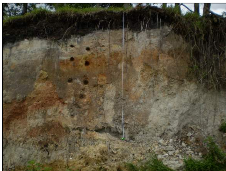
Figura 49: Foto do perfil 1. Atentar para a variação da coloração e da textura e a presença de uma camada orgânica no topo do perfil.
