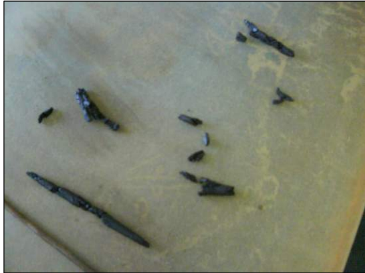
Figura 38: Modelagem de cilindros no ensaio de Limites de Atterberg. Autor: GIFFONI, S. Data: 04 mar. 2009.
