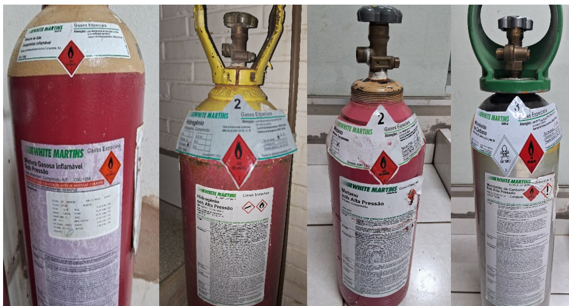
Figura 16. Cilindros de mistura padrão de seis gases, hidrogênio, metano e monóxido de carbono, respectivamente.
