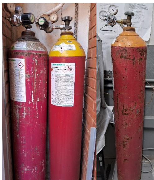
Figura 15. Cilindros de ar sintético, gás hidrogênio e gás hélio, respectivamente.
