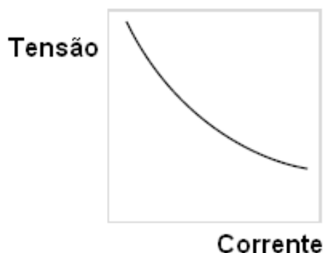
Figura 1.4 – Característica de uma descarga elétrica em gases.
