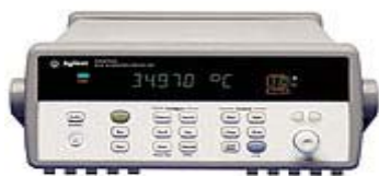
Figura 5.3 – Agilent 34970A - unidade de aquisição de dados.
