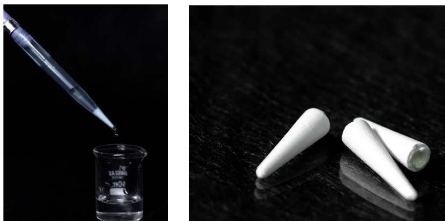
Figura 11. Monolito de poli(TMPTA- co -EDMA) nas condições otimizadas de polimerização in situ .
