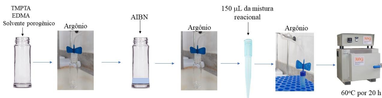
Figura 5. Fluxograma do processo de preparação do monolito de poli(TMPTA-EDMA).
